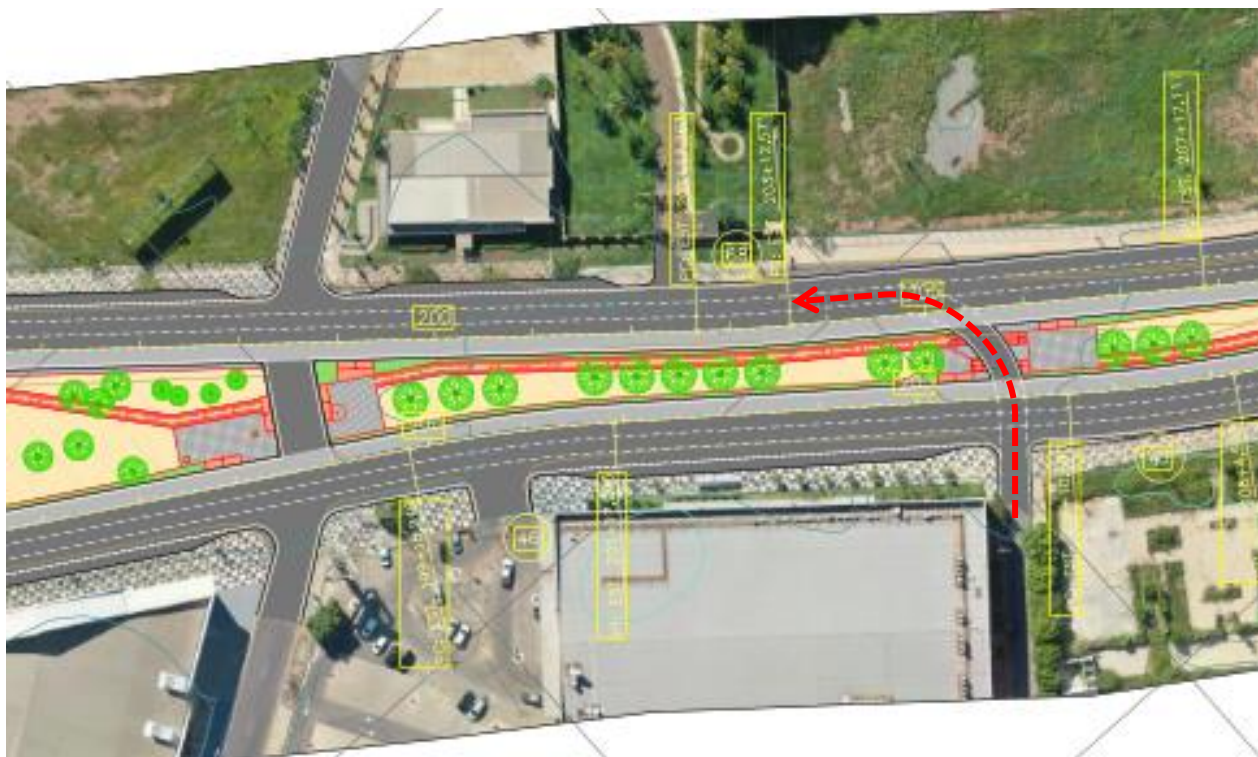
Figura 3: passagem semaforizada em canteiro central na Estaca 206
